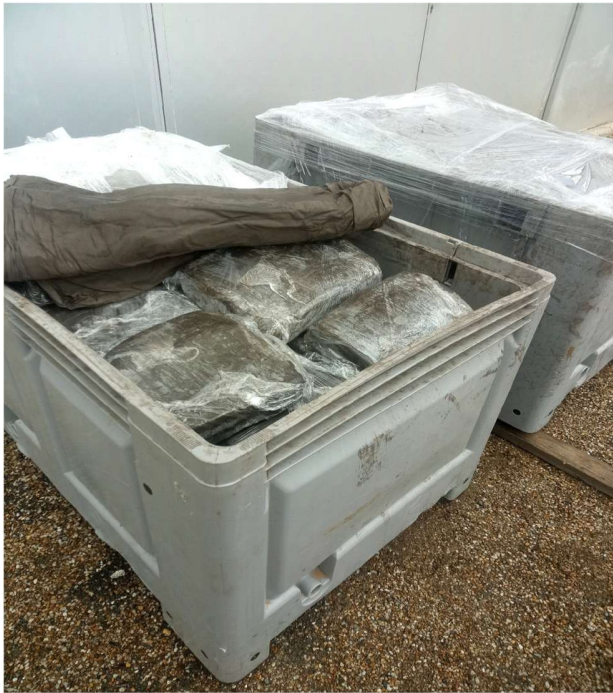
PHOTO 1 : Conditionnement stockage argile
